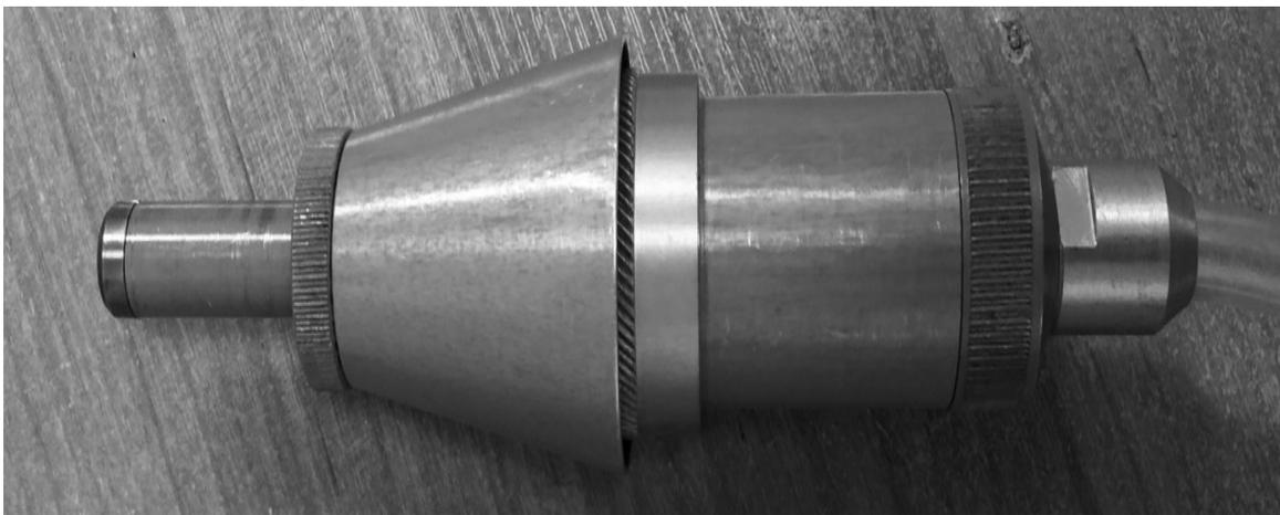
Рис. 1. Пневмоборомашина.
