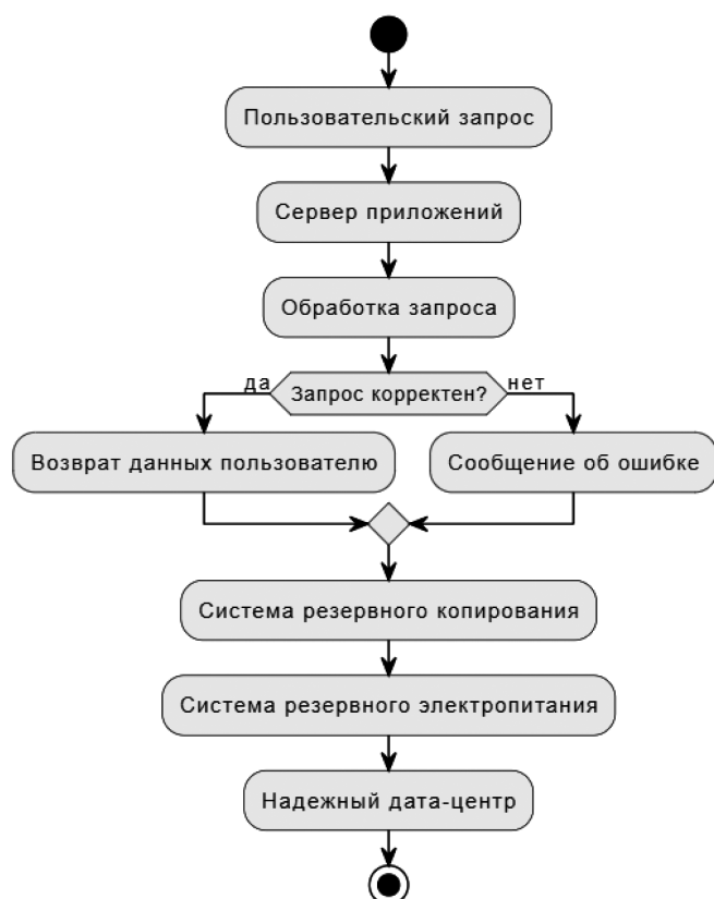
Рис. 1. Алгоритм обработки запроса в основных компонентах SaaS
