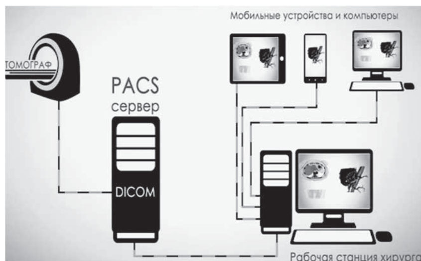
Рис. 1. Структура системы предоперационного планирования, анализа и хранения данных. Цит. по [3]
