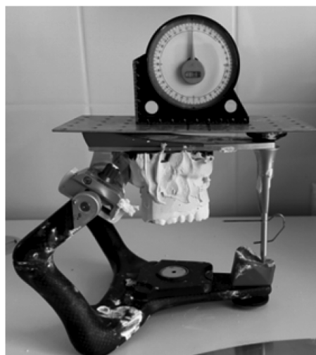
Рис. 10. Проверка уровня горизонта в артикуляторе Amann Girschbach Artex CN, горизонт в норме
