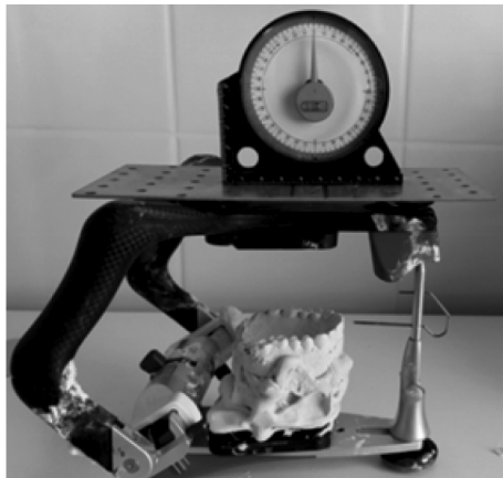
Рис. 8. Проверка уровня горизонта в перевернутом артикуляторе Amann Girschbach Artex CN, отклонений нет
