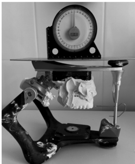
Рис. 7. Проверка уровня горизонта в артикуляторе Amann Girschbach Artex CN, отклонений нет
