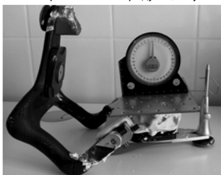
Рис. 9. Проверка уровня наклона модели в/ч в артикуляторе Amann Girschbach Artex CN
