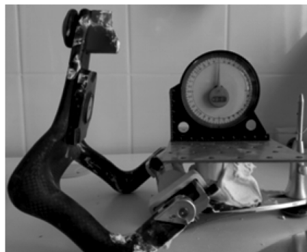
Рис. 11. Проверка уровня наклона модели в/ч в артикуляторе Amann Girschbach Artex CN
