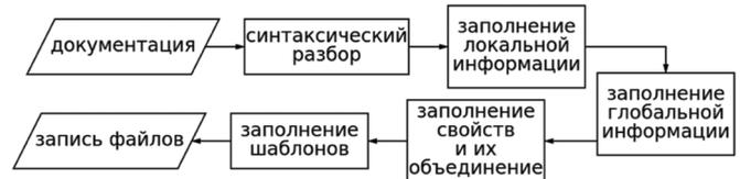
Рис. 1. Блок-схема генератора
