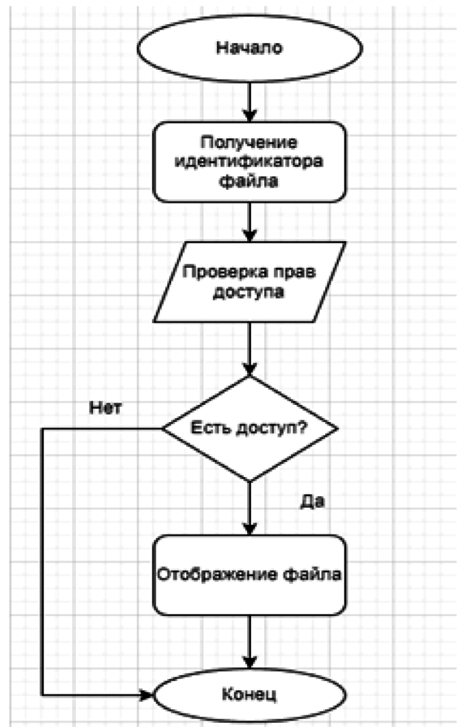
Рис. 2. Блок-схема работы модуля интеграции
