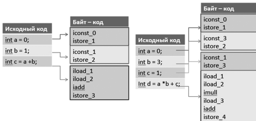
Рис. 3. Пример исходного кода, скомпилированного в class-файл с демонстрацией сопоставления исходного кода и инструкций байт-кода соответствующих ему
