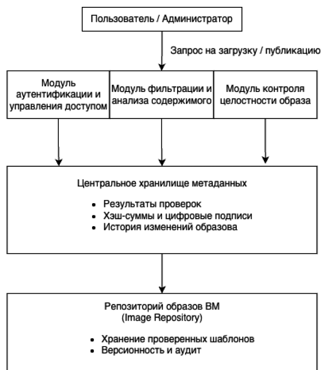
Рис. 3. Модель взаимодействия модулей системы безопасности образов виртуальных машин: аутентификация, фильтрация и контроль целостности, объединённые через центральное хранилище метаданных
