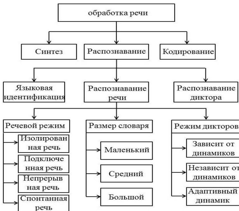
Рис. 1. Классификация обработки речи
