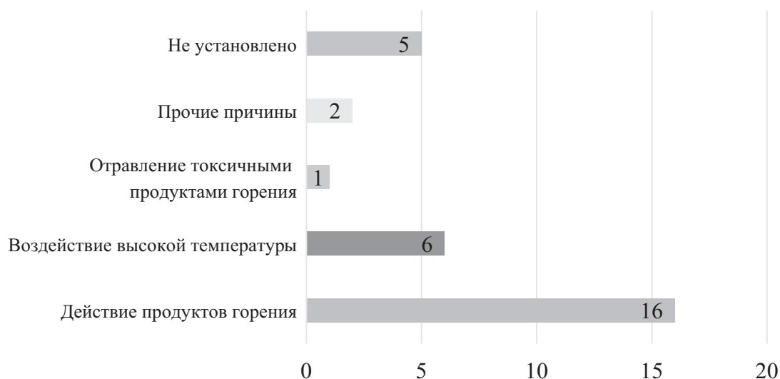
Рис. 2. Причины гибели людей в результате пожаров, произошедших в УСО за период с 2007 по 2023 год
