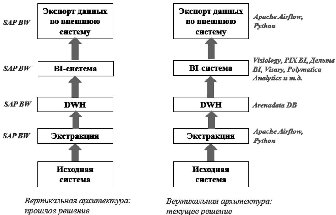
Рис. 1. Схема вертикальной архитектуры ПО для прошлого и текущего решений
