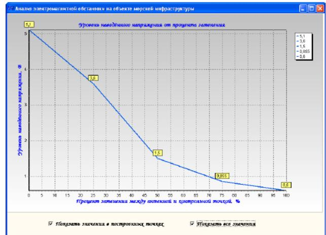
Рис. 13. Результаты расчёта зависимости уровня наведённого напряжения от процента затенения между излучающей антенной и контрольной точкой при фиксированной мощности излучения и расстоянии до него
