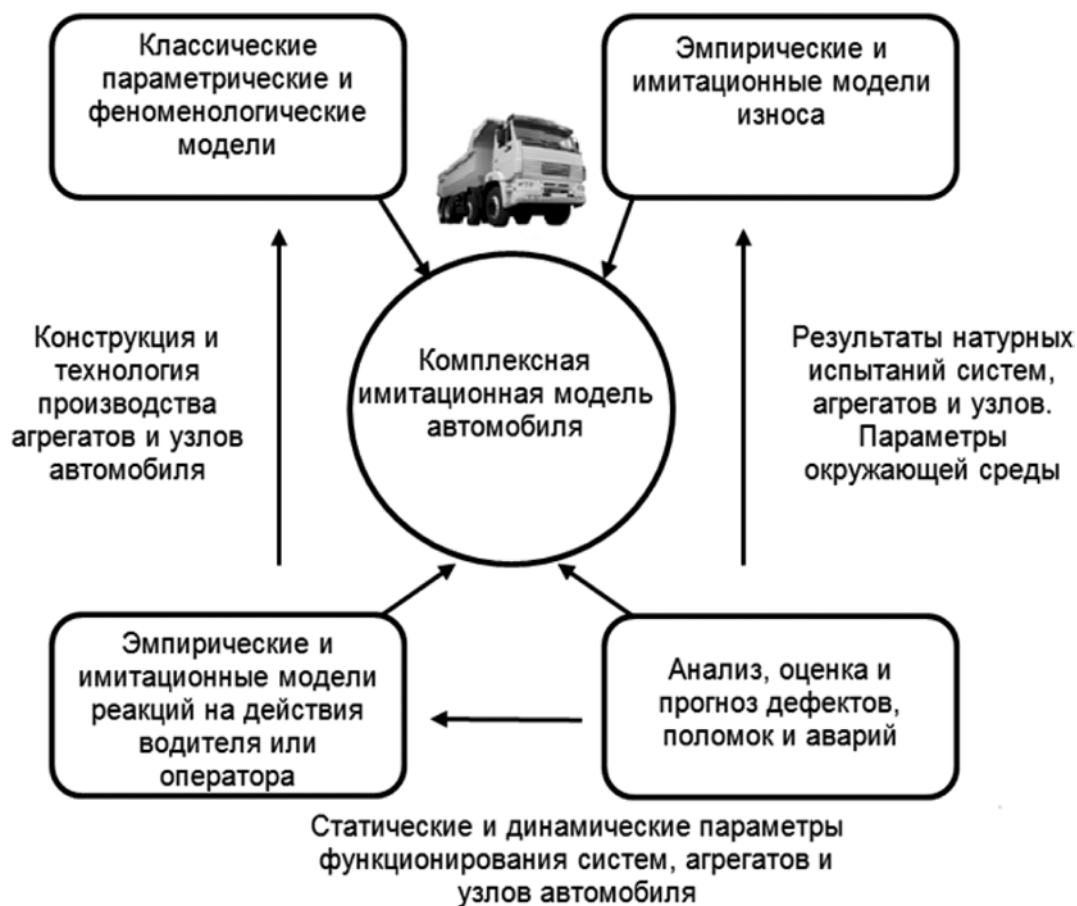
Рис. 1. Компоненты комплексной модели роботизированного автомобиля
