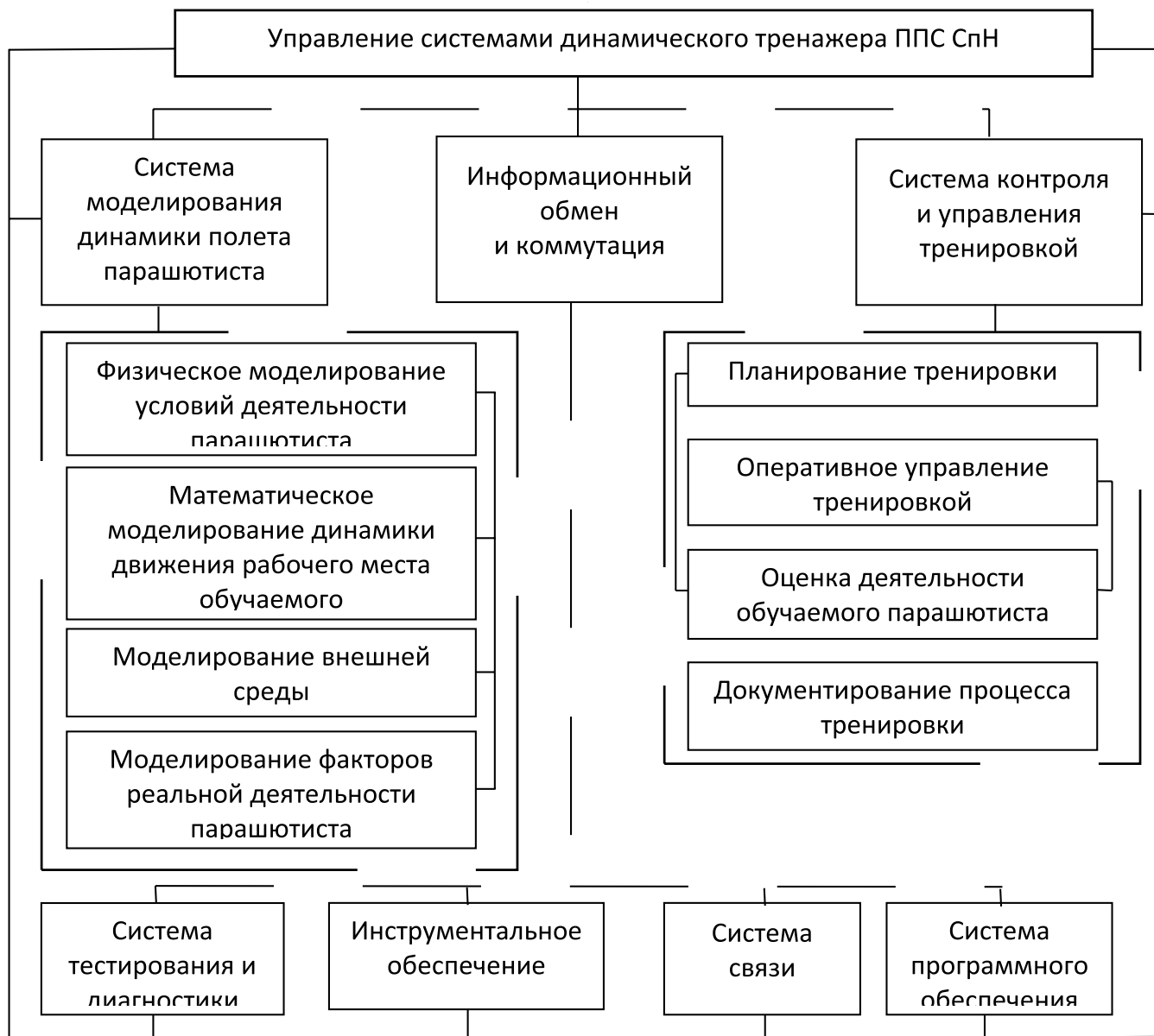
Рис. 4. Функциональная схема управления системами динамического тренажера освоения парашютной системы специального назначения
