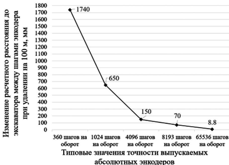
Рис. 7. Зависимость изменения расчетного размера отрезка АВ на один шаг у энкодеров с разным соотношением шагов/оборотов на расстоянии 100 метров до экскаватора
