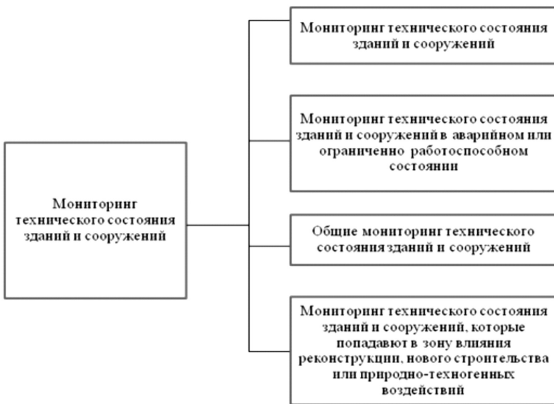
Рисунок 1. - Виды мониторинга технического состояния зданий и сооружений.
