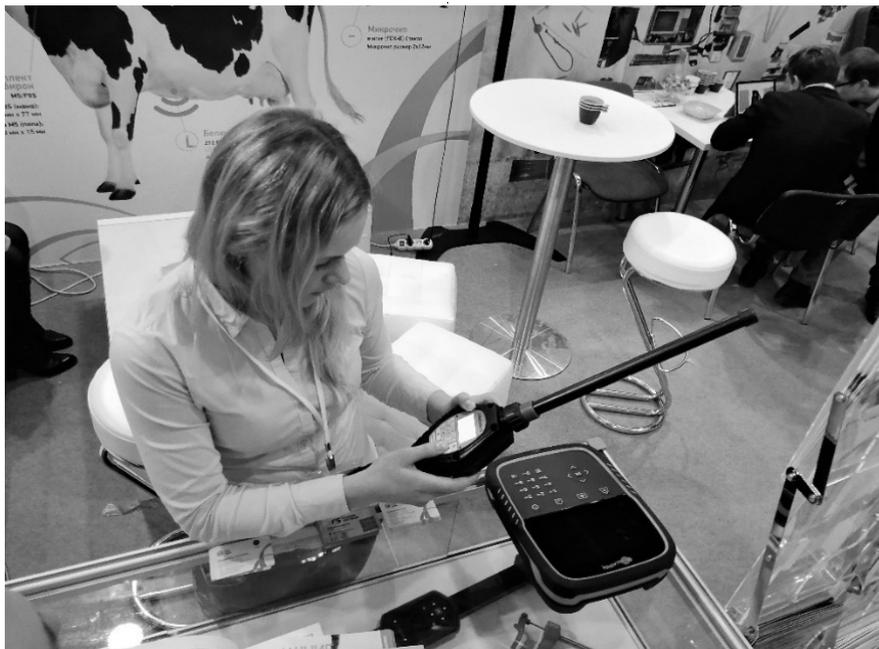
Рис. 4. Ручные считыватели меток на стенде ISBC представлены моделями Bioscontrol HHR3000Pro (на фото) и Agrident AWR300. Оба считывателя совместимы с программным комплексом Селэкс, разработки РЦ «Плинор». | MForum.ru Все иллюстративные материалы взяты и переработаны из статьи «RFID в животноводстве. Ветеринария и RFID — Применение RFID»
