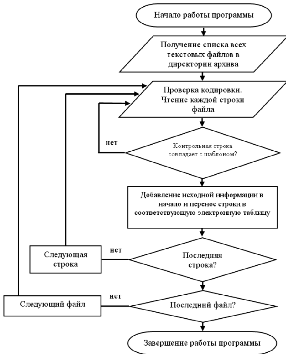
Рисунок 4. Блок-схема алгоритма разработанного программного обеспечения.
