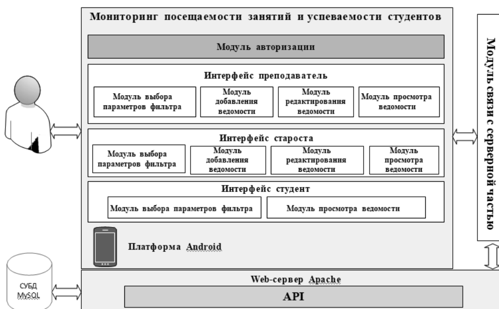
Рис. 3. Архитектурная схема мобильного приложения мониторинга посещаемости занятий и успеваемости студентов
