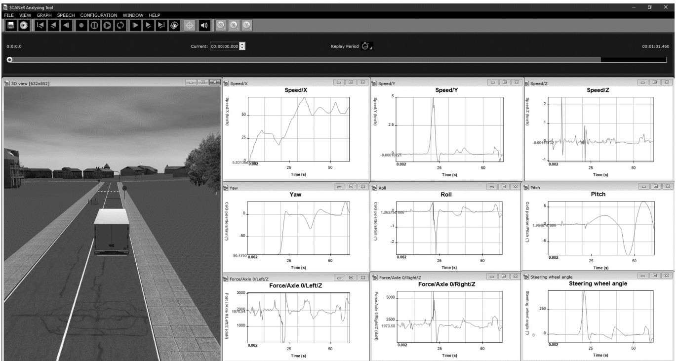
Рис. 3. Анализ виртуального испытания в Ansys VRXPERIENCE Driving Simulator
