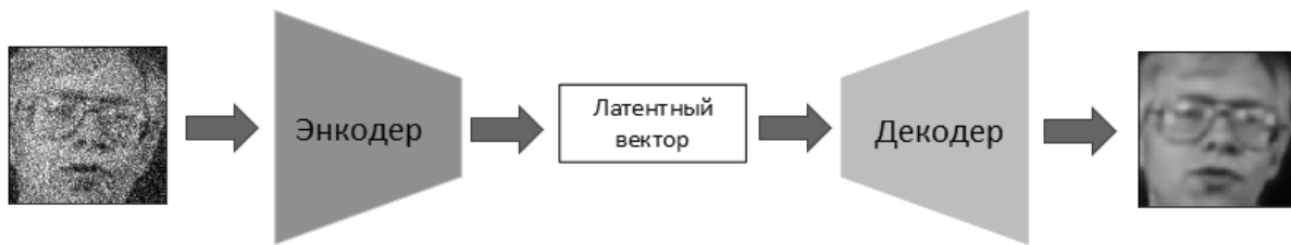
Рис. 1. Функционирование автоэнкодера по шумоподавлению изображения.
