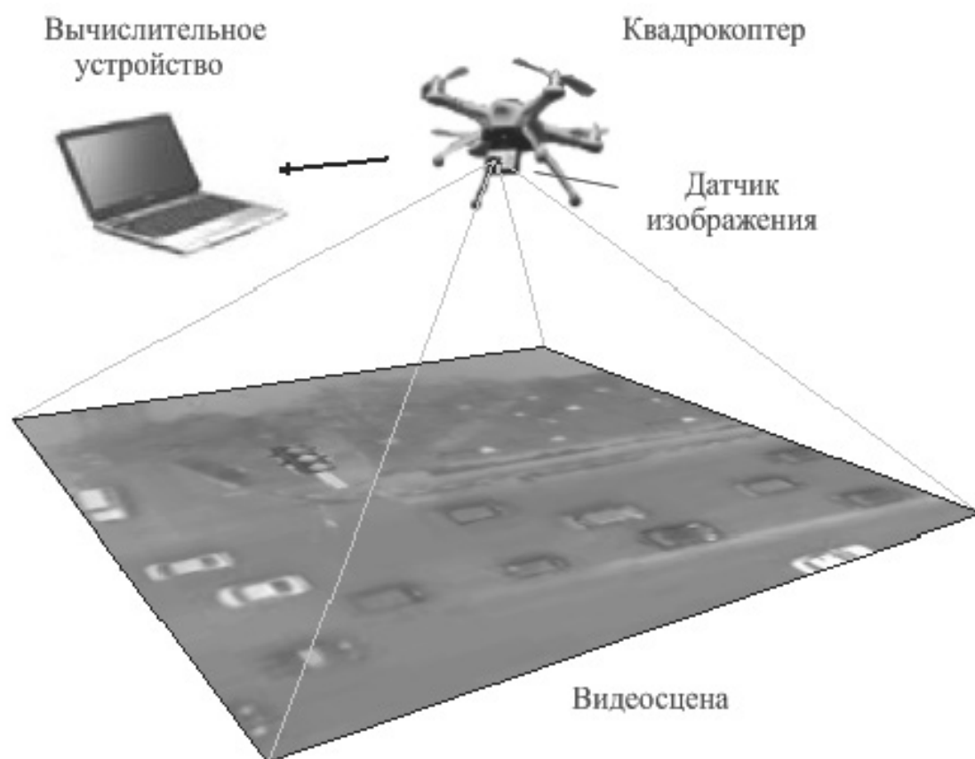
Рис. 1. Измерительная система на базе квадрокоптера
