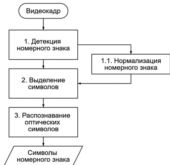
Рис. 1. Классическая схема распознавания номерных знаков с возможным дополнительным (1.1) шагом нормализации
