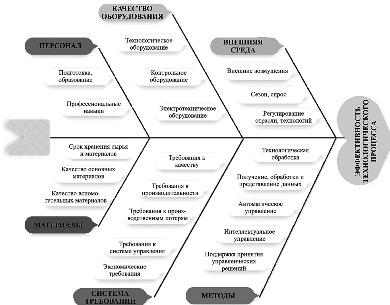
Рис. 1. Причинно-следственная диаграмма влияния источников неопределенности на эффективность управления технологическими процессами
