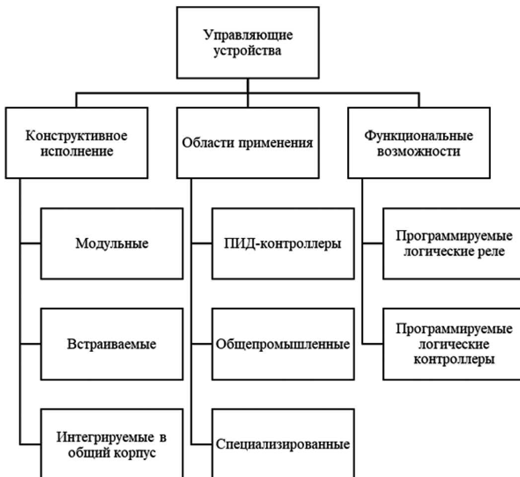
Рис. 1. Классификация устройств, необходимых при автоматизации биотехнологических процессов в пищевой промышленности (источник: разработано авторами)
