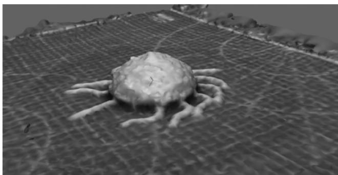
Рис. 7. Результат построения 3D модели из оригиналов фотографий объекта
