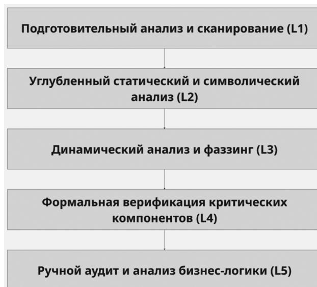
Рис. 2. Схема проведения автоматизированной проверки безопасности смарт-контракта
