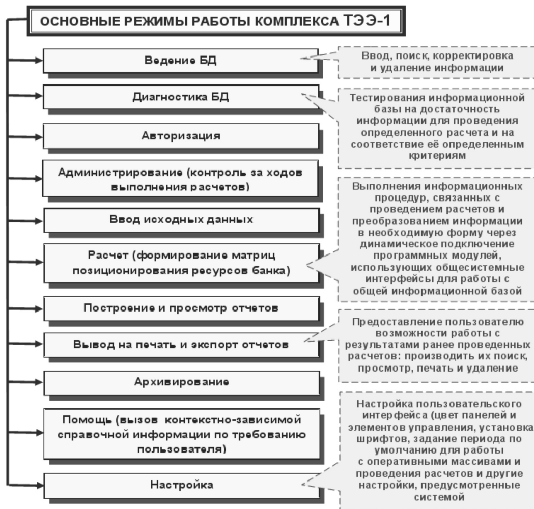
Рисунок 4 Основные режимы работы комплекса ТЭЭ-1.
