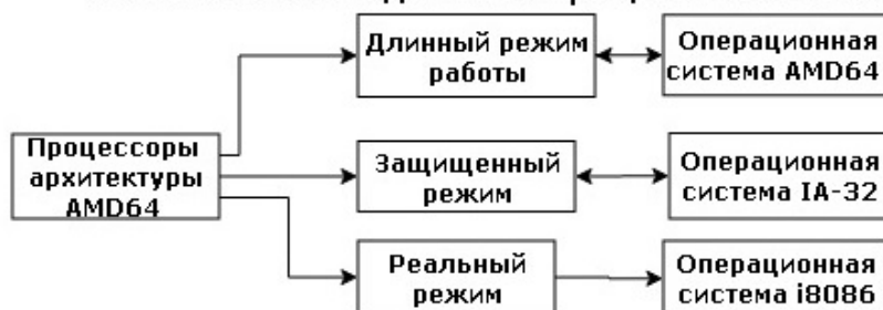
Соответствие режима работы микропроцессора AMD 64 и возможных моделей операционных систем
