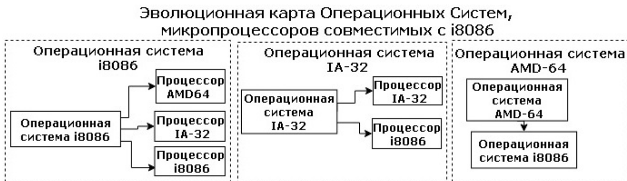
Соответствие режима работы микропроцессора AMD 64 и возможных моделей операционных систем
