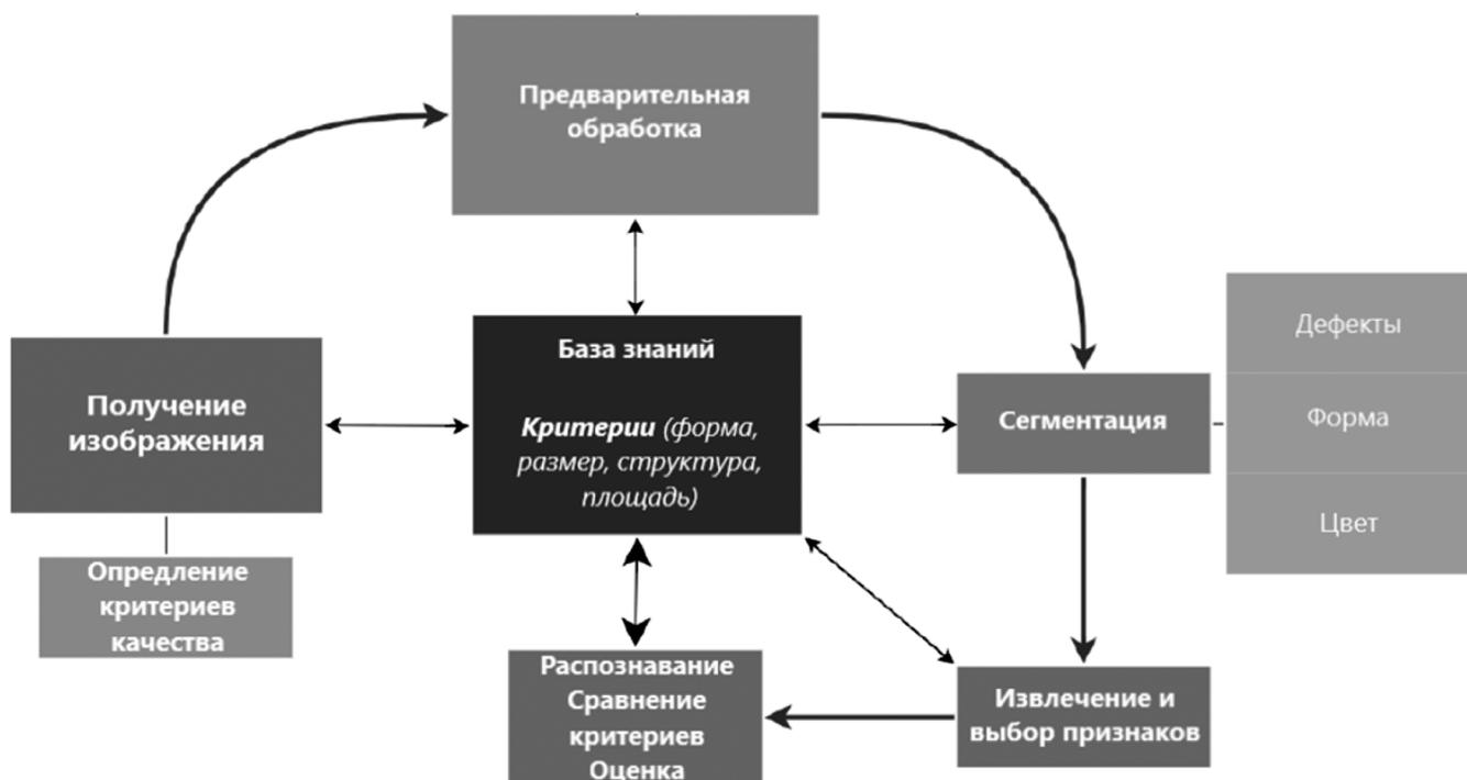
Рис. 1. Схема основных этапов использования компьютерного зрения для обработки цифровых изображений
